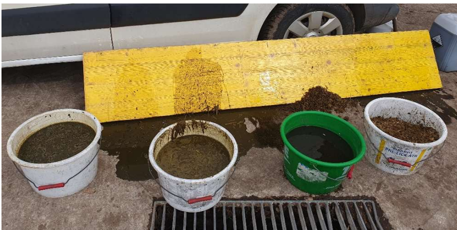
Praxisnahe Beispiele: Gülle unterschiedlich behandelt: EM/Seperator/ Kohle, Fliesstests auf Schaltafel
